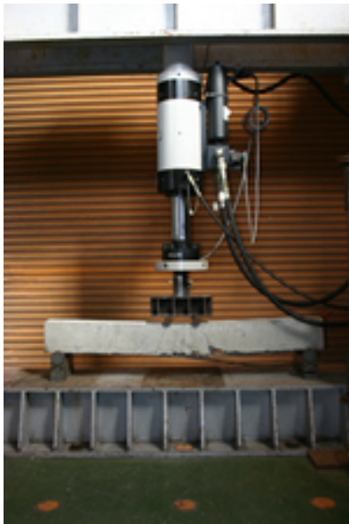
左：対象2点集中荷重単純梁の荷重試験、右：せん断破壊した試験体
