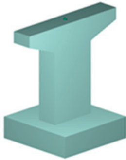
図－3 対象橋脚：単柱式 RC 橋脚
