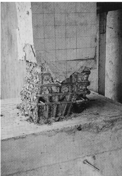
写真-2.2 曲げ破壊
