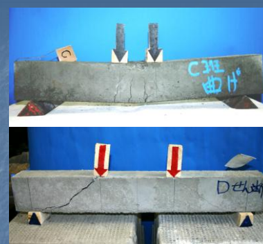
RC梁の小型静的載荷実験 (試験体の終局状況)
