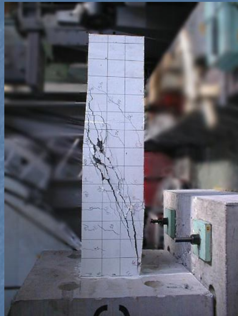
RC単柱の静的載荷実験：構造実験棟/1998年
