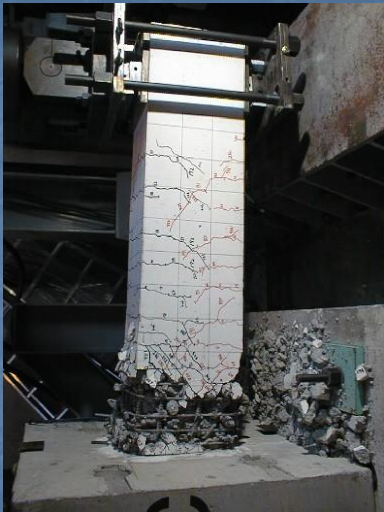
RC単柱の静的載荷実験：構造実験棟/1998年
