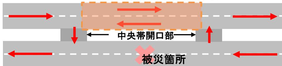
通行止め(状態C) 開口部間の上下線がともに損傷
