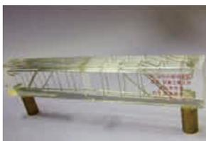
吉川先生が開発した梁のスケルトン模型。鉄筋コンクリートの梁にどのような状態で鉄筋が埋設されているかが一目瞭然。配筋を3次元的にとらえることができるため、学生の理解も格段の差があるという。
