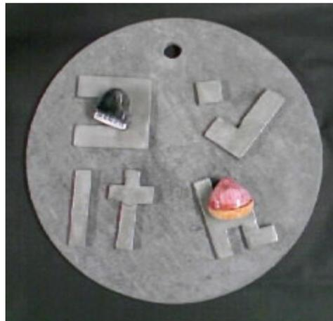
写真8 砂鉄を混入したコンクリート製の看板
