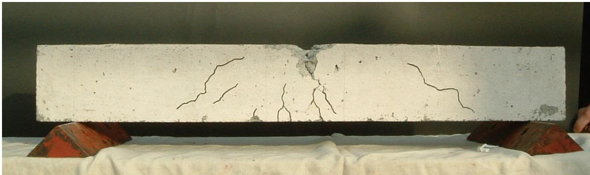
写真3 鉄筋コンクリート梁の縮尺模型(幅 7cm,高さ 10cm, 長さ 70cm)
